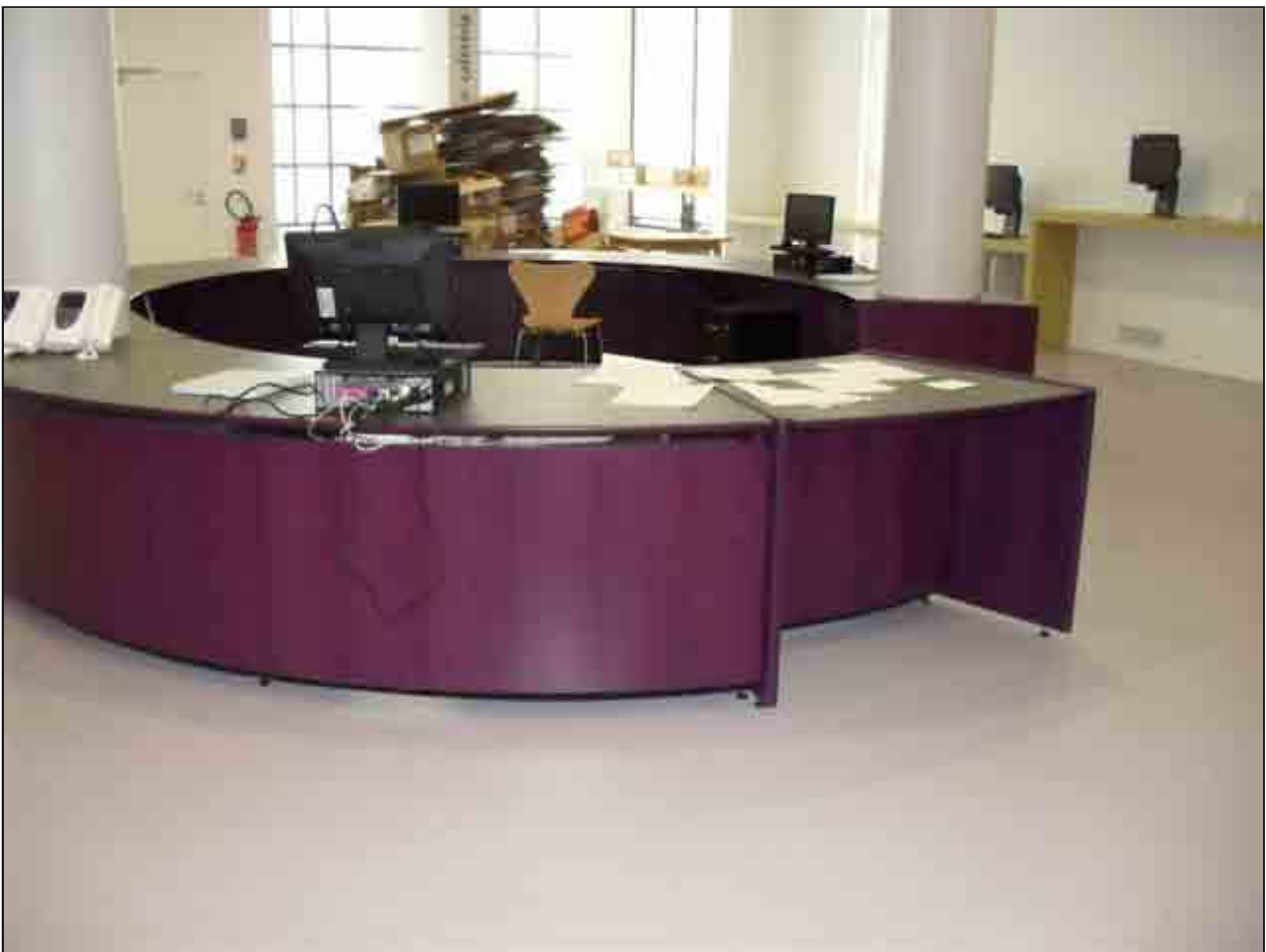
Médiathèque Marguerite Duras, Paris 20 e Exemple d'un établissement où le mobilier est surbaissé afin de permettre l'accueil de personne en situation d'handicap (usagers en fauteuil roulant) ou de petite taille (enfants)
